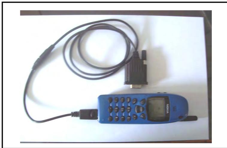
**Gambar 4.2** Gambar Kabel data yang sudah dihubungkan ke Handphone
